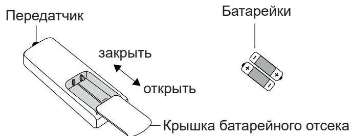
Для замены батареек переверните пульт, нажмите на крышку батарейного отсека и сдвиньте ее.
